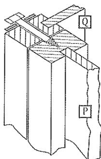
Enfiler les tirefonds et rondelles dans les trous du panneau arrière Q puis visser dans les panneaux latéraux P
